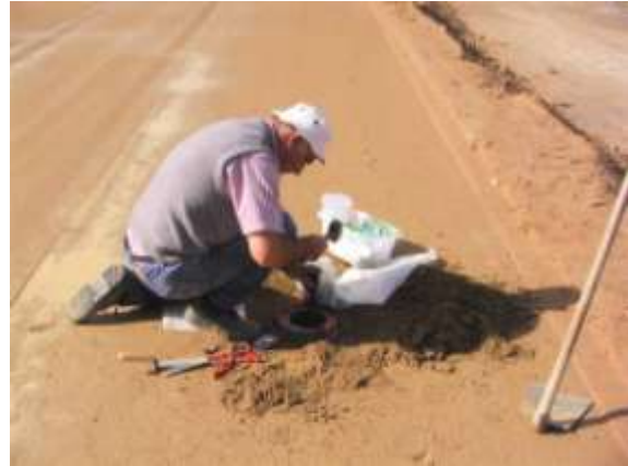
5-6. kép, ASTM Sand-filling homok-kitöltés vizsgálat
