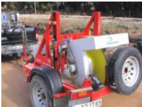
10-11. kép, Portancemetre folyamatos teherbírás mérési módszer
