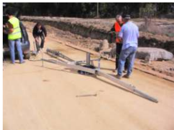
16-17. kép, Statikus teherbírás vizsgálat d=600 mm tárcsával
