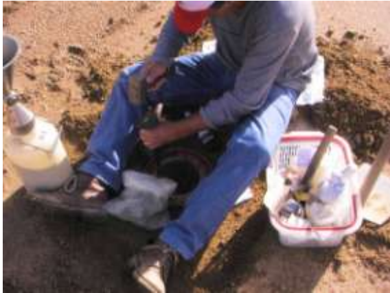
5-6. kép, ASTM Sand-filling homok-kitöltés vizsgálat
