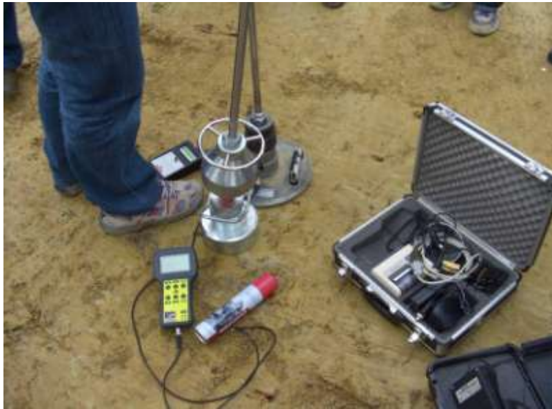
9.kép, Kistárcsás és nagyárcsás LFWD könnyűajtósúlyos berendezések
