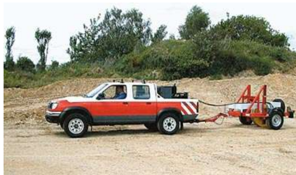
10-11. kép, Portancemetre folyamatos teherbírás mérési módszer
