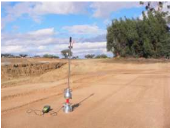
7-8. kép, ANDREAS új dinamikus tömörség- és teherbírás mérő műszere
