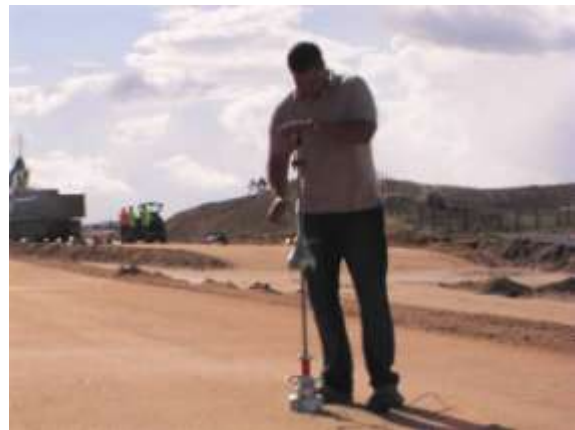
7-8. kép, ANDREAS új dinamikus tömörség- és teherbírás mérő műszere
