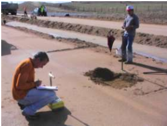
3. kép, Izotópos tömörségmérés
