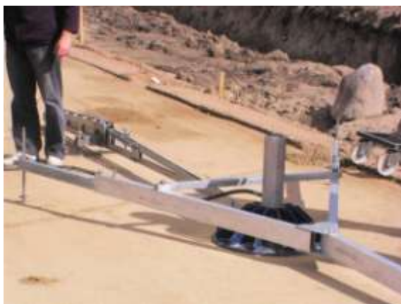
16-17. kép, Statikus teherbírás vizsgálat d=600 mm tárcsával
