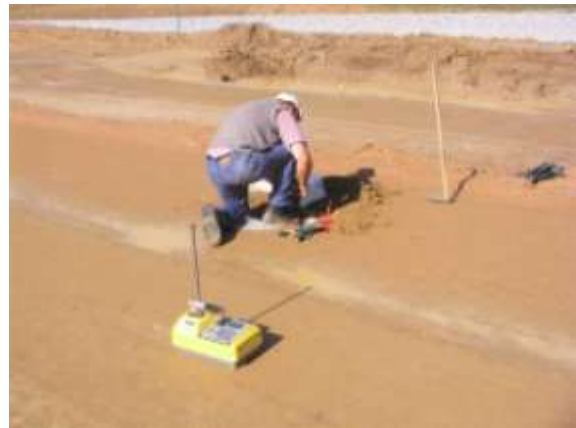
4. kép, Homok-kitöltéses módszer
